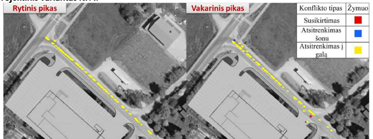
25 pav. Potencialūs konfliktiniai taškai. Projektinis variantas Nr. I (kairėje – rytinis, dešinėje – vakarinis pikas)
