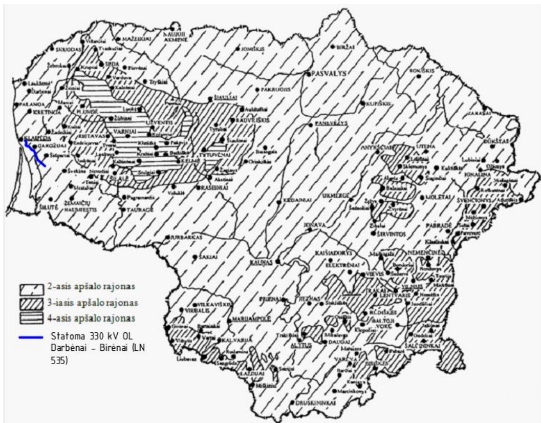
11.4.1.3 pav. Lietuvos Respublikos teritorijos rajonavimo pagal elektros tinklo apkrovas nuo apšalo žemėlapis
