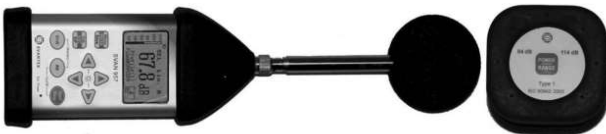
2 pav. SVAN 957 Triukšmo ir vibracijos matuoklis.
