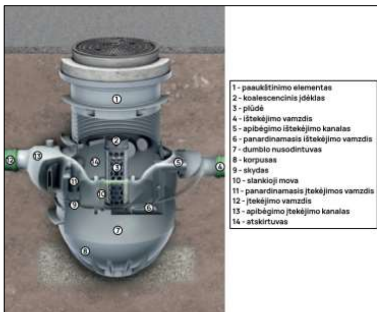
4 pav. „Oleopass P“ nuotekų valymo įrenginio technologinis brėžinys
