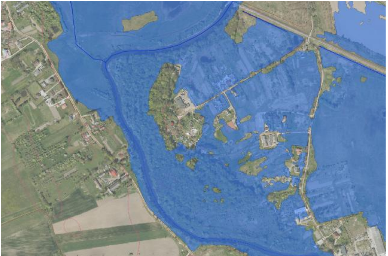
36 pav. Potvynio vandens plotas kai tikimybė 1% L 4L, L 5R, L 6L ir L 7L pylimų įrengimo vietovėse.
