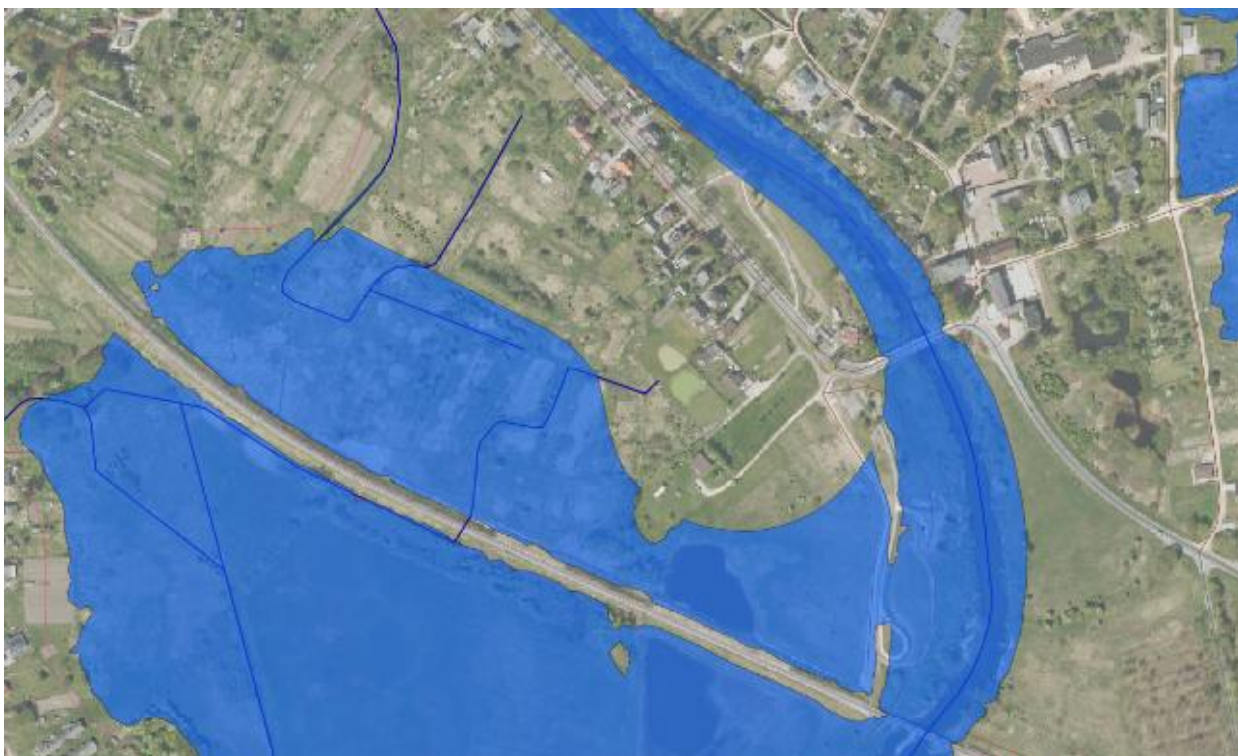
33 pav. Potvynio vandens plotas, kai tikimybė 1 % siūlomų pylimų L 1R, L 2R ir L 3L vietovėse.
