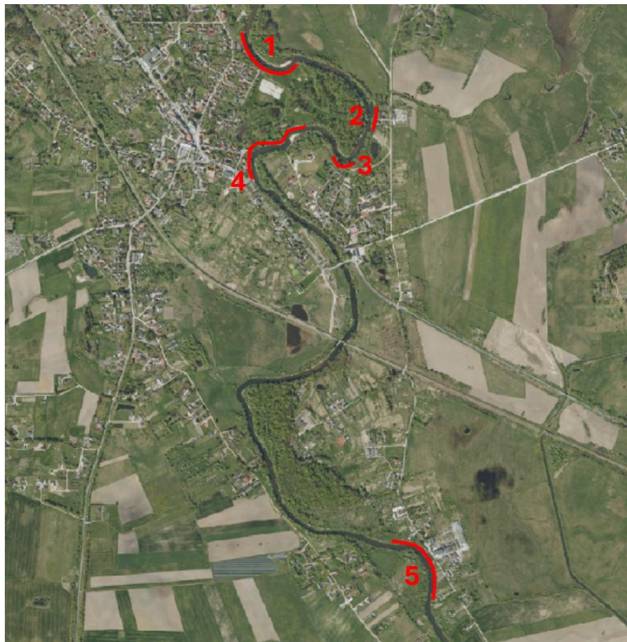
47 pav. Siūlomos erozijos apsaugos priemonių vietos upės krantuose.
